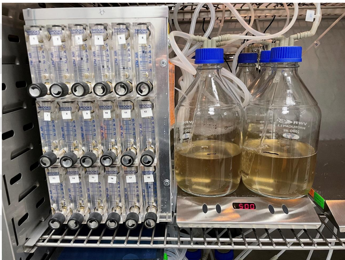
Figura 4. Immagine del set-up del test di biodegradabilità
