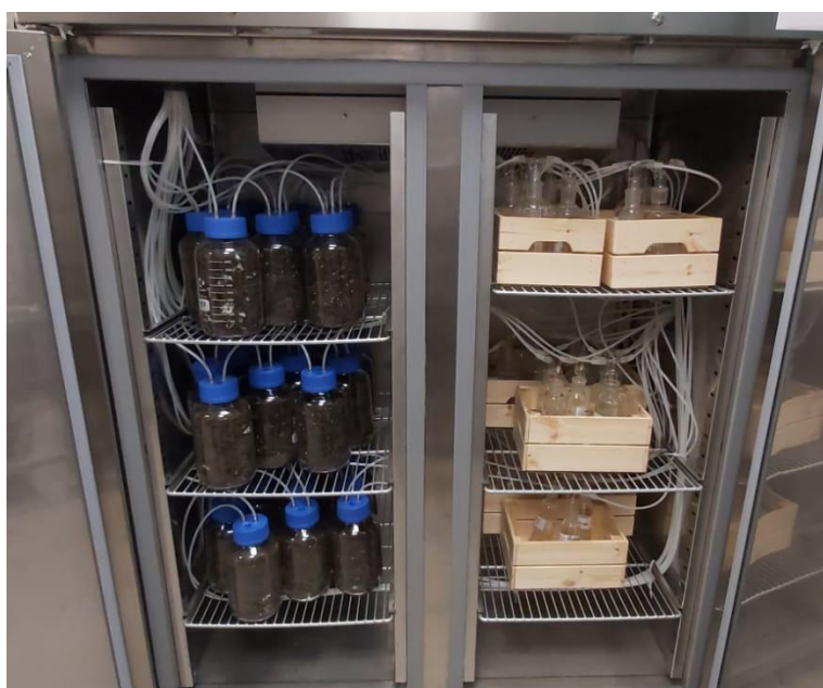
Figura 4. Immagine dei reattori nella camera climatica per il test di biodegradazione in condizioni di compostaggio.
