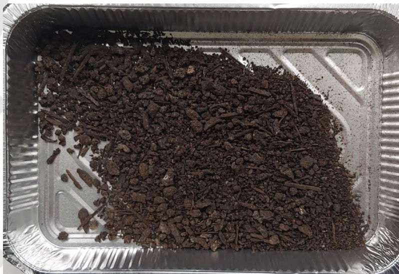
Figura 21. Substrato setacciato del campione con il materiale test alla fine del test di disintegrazione.
