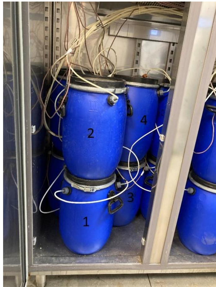
Figura 10. Immagini della strumentazione per il test di disintegrazione.
